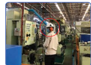
รูปที่ 16 ตัวอย่างการสวมใส่อุปกรณ์ป้องกันเสียงดังขณะปฏิบัติงาน
